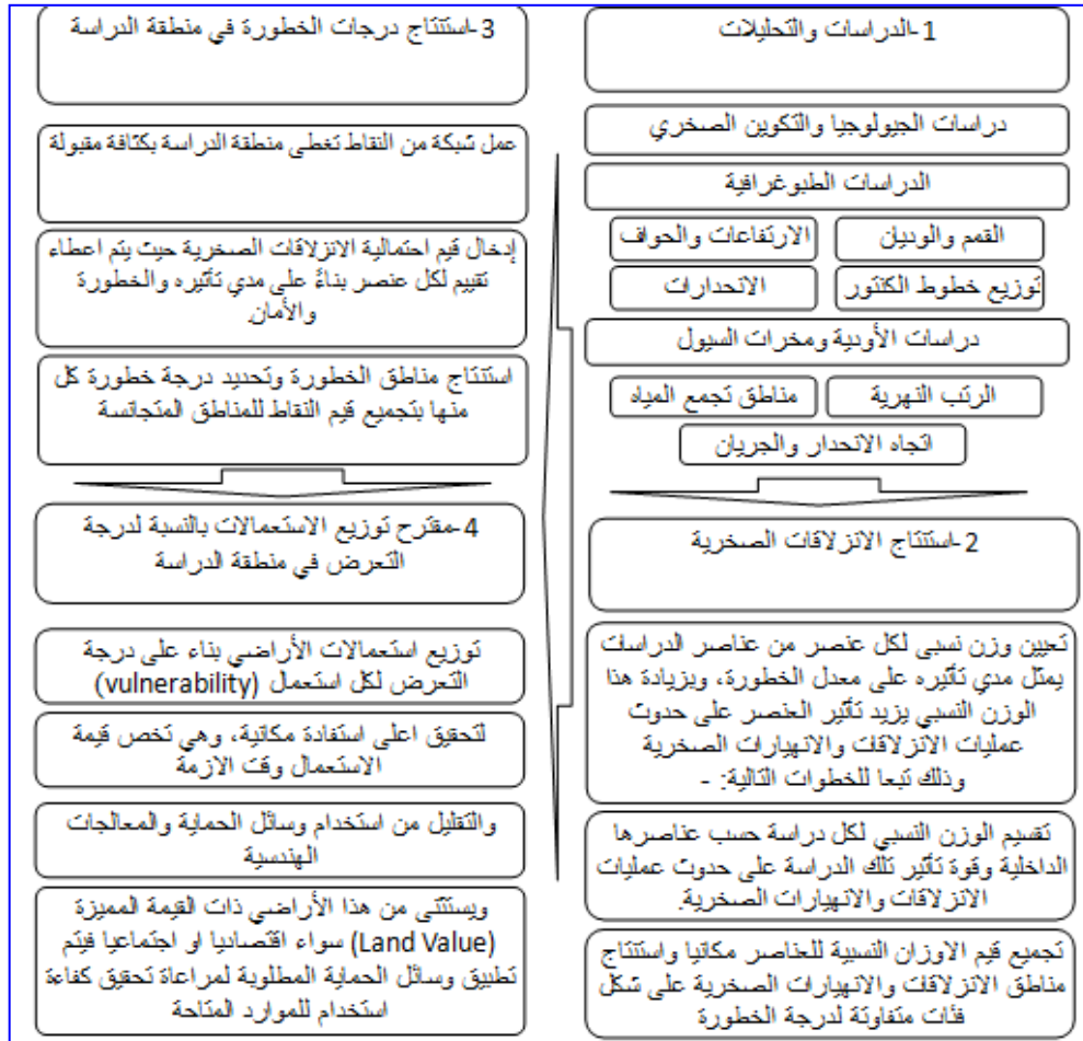
شكل (14). نموذج مقترح لاستدامة التنمية العمرانية بالمناطق الجبلية المهددة بخطر الانهيارات والانزلاقات الصخرية (أعداد الباحث).
